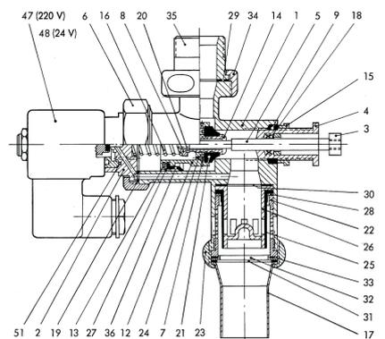
NIL-Steckbeckenspüler, Modell 601, mit aufgesetztem Magnetventil
